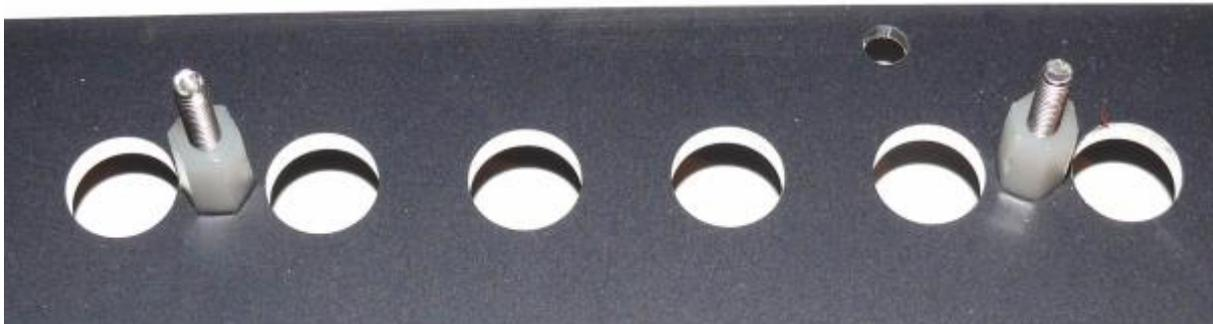
So werden die Bananenbuchsen in die Hauptplatine geschraubt. Dabei wird der untere Plastikring der Buchse einfach umgedreht, um die richtige Einschraublänge zu erhalten:
