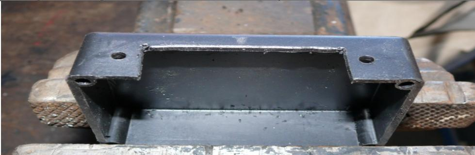
Zur Durchführung der Kabel muss im Boden ein Ausschnitt erfolgen. Vorteilhaft sind Stufenbohrer und Stichsäge:
