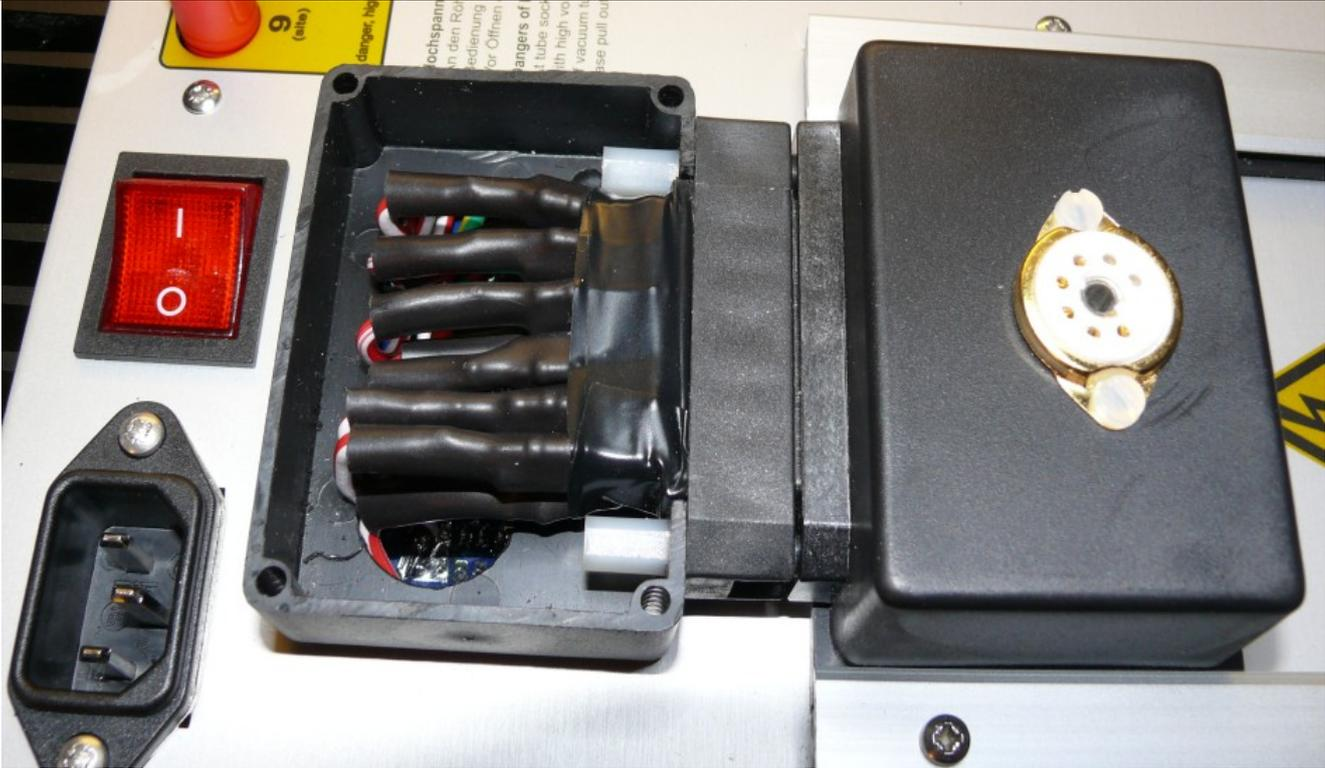
Auf die Plastikbox wird der mit der Box mitgelieferte Deckel aufgesetzt und beides mit der Frontplatte verschraubt. Bei mir passen Schrauben M3 x 30.
