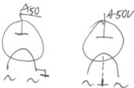
bei Wechselstromheizung liegt am gesamten Heizfaden identisches Gleichstrompotential an (die Spannung schwankt um 0 Volt)
