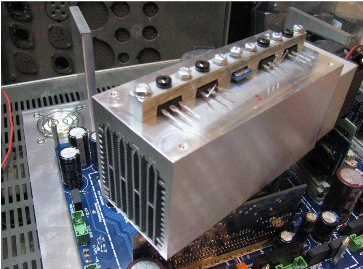
Montageprinzip der Mosfets auf dem Lüfteraggregat
