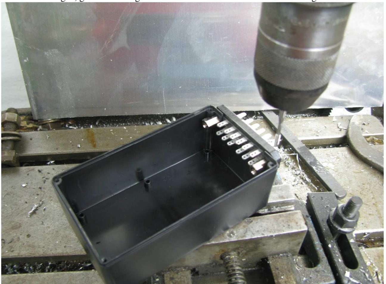
M3er Gewinde schneiden mit scharfen Maschinengewindebohrer. Bohrmaschine mit R-L-lauf
