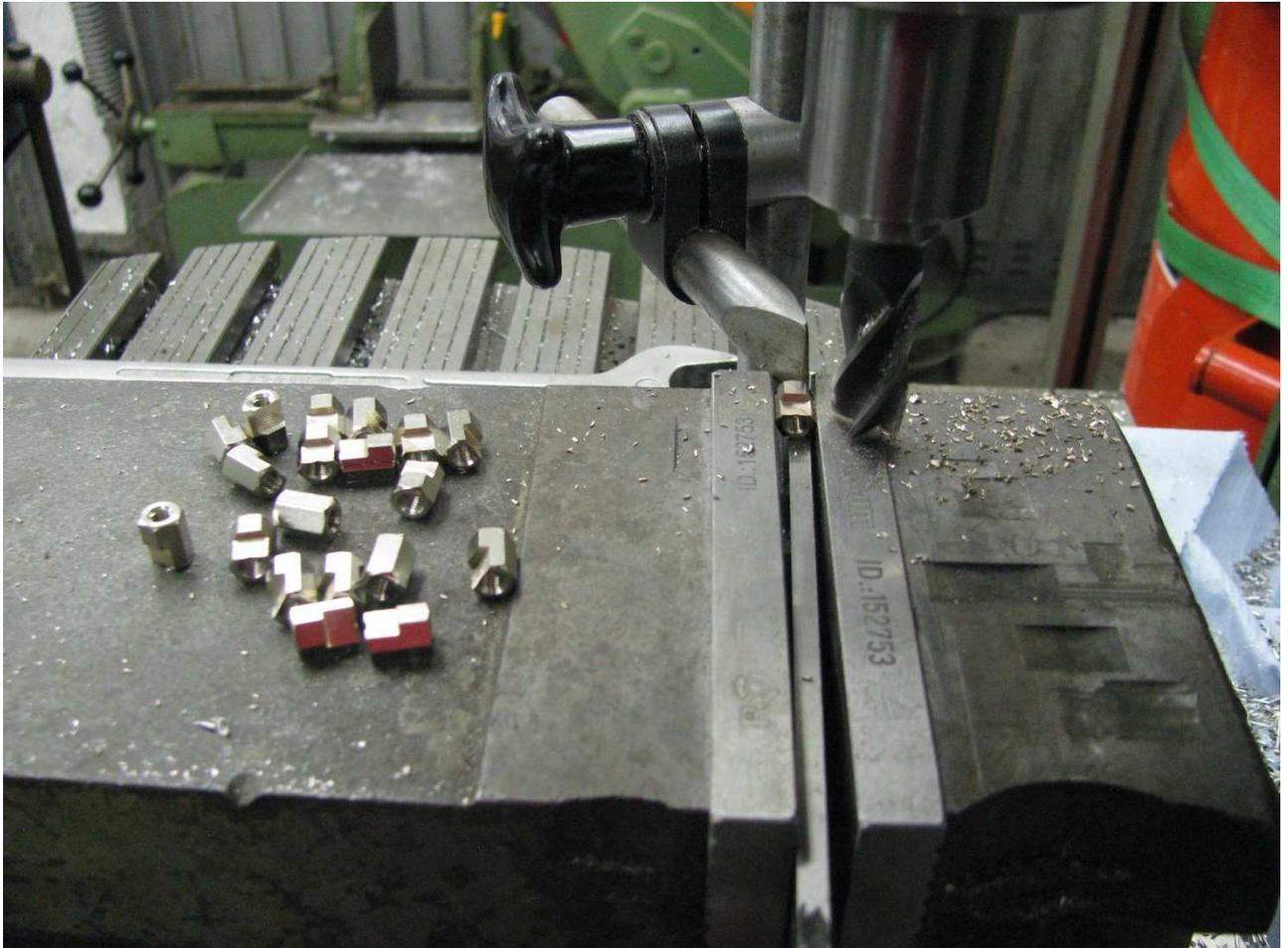
Absatz fräsen einer M4er Mutter für die Messerleistenverschraub. bei den langen Fassungsboxen
