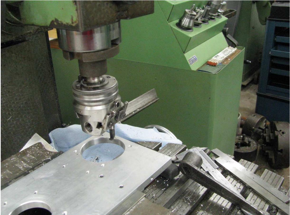
eigene Herstellung Trägerplatte für Kühlblock: Ausspindeln einer größeren Bohrung.
