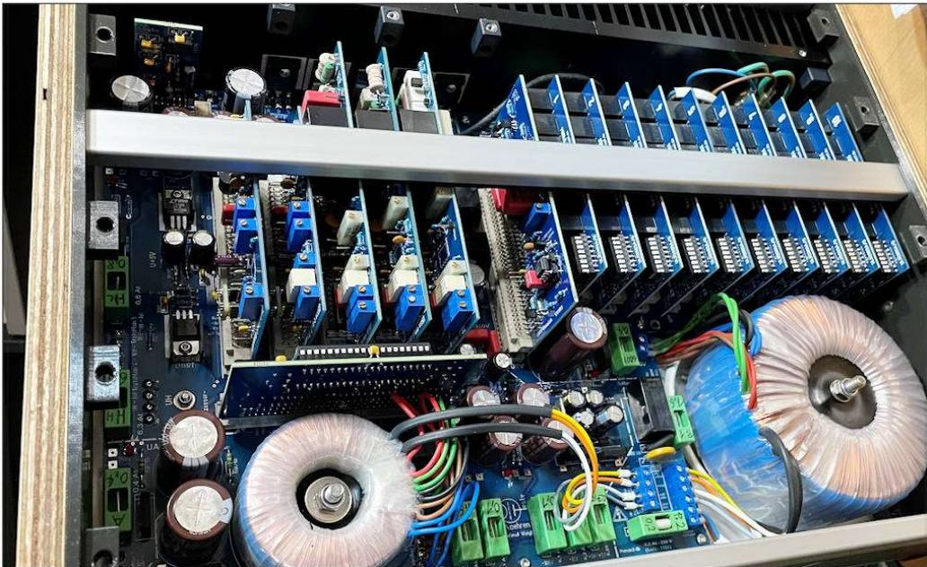
Diese ist absichtlich so positioniert, dass sie in einem kleinem Abstand unter den meisten Steckkarten entlangläuft. Mit gedruckten Teilen schließe ich die Lücke, indem ich eine formschlüssige Verbindung zu den Kanten der Steckkarten herstelle:
