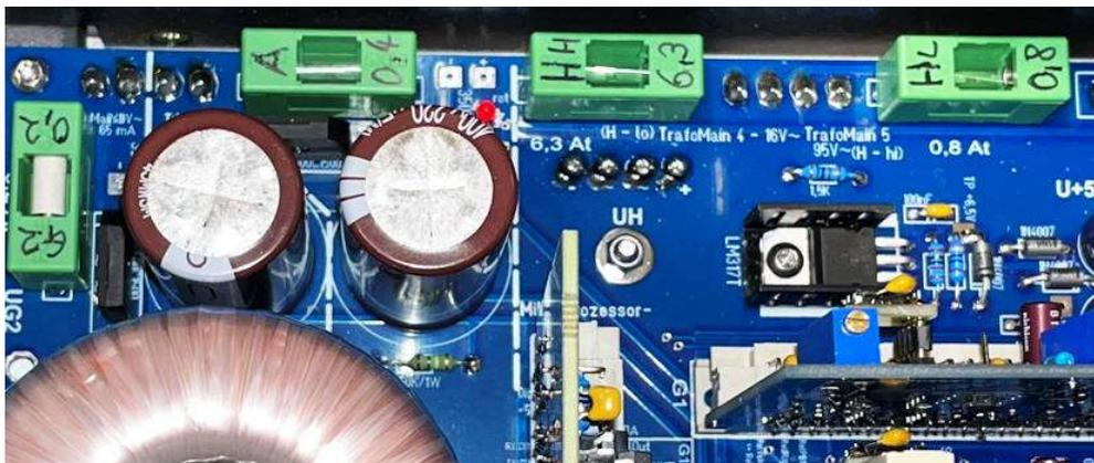
Wenn das alles passt und nichts in Rauch aufgegangen ist, geht die weitere Inbetriebnahme mit Unterstützung der PC-Software. Dafür werden zunächst nur die Prozessorkarte, die USB-Karte, sowie die Relais-Karten bestückt. Mit der Software kann man dann alle Relais durchprüfen. Hat auch das geklappt, so geht es an den aufwändigeren und fummeligeren Teil der Inbetriebnahme:
