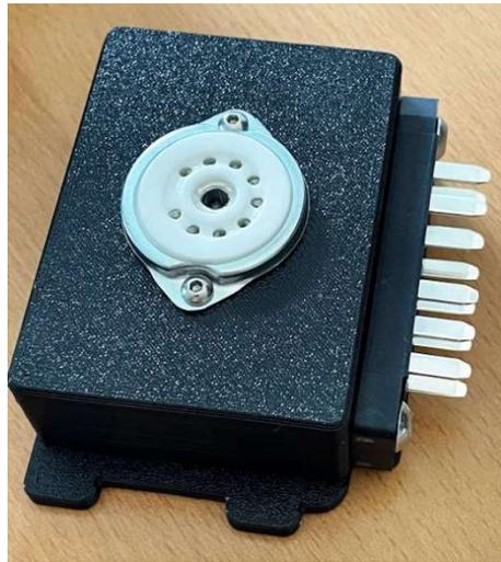
Eine Fassungsbox ist somit der Adapter zwischen der zu testenden Röhre und der Federleiste am RoeTest.
