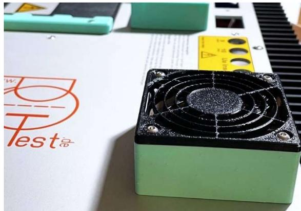
Hierbei handelt es sich tatsächlich nur um ein einziges Druckteil, bei dessen Druck einfach zur richtigen Zeit das Filament zu einer anderen Farbe gewechselt wurde. Die von außen immer noch sichtbaren Teile des Lüfters habe ich dann noch so gut wie möglich mit einem schwarzen Edding gefärbt – und schon passt das Farbschema wieder.
