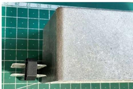
Damit der Ausschnitt und die Löcher für die M4-Schrauben an der richtigen Stelle landen, wird vorübergehend eine gedruckte Schablone an das Gehäuse geschraubt:
