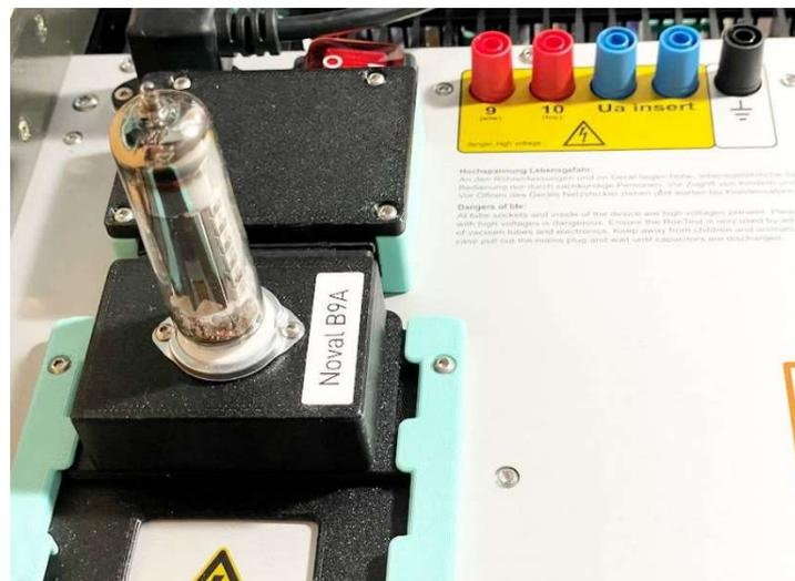
In der Windows-Software des RoeTest lädt man dann einfach die Röhrendaten aus der umfangreichen Datenbank und kann dann verschiedene Tests durchlaufen lassen:
