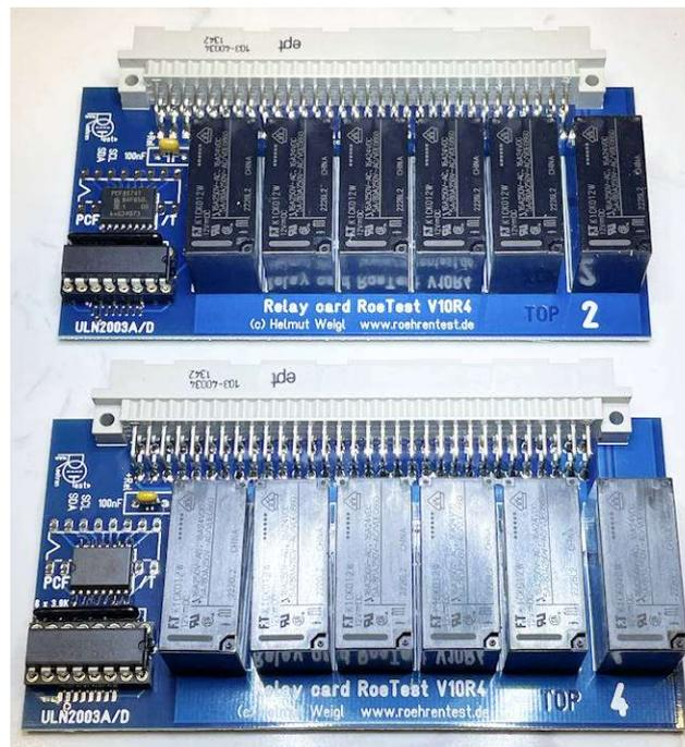
Da man 10 Stück davon aufbauen muss, die alle fast identisch sind, habe ich hier einfach an allen Platinen zugleich gearbeitet. Durch die vielen Relais – 60 an der Zahl! – wiegen die Relaisplatinen dann auch insgesamt stattliche 1,2 kg!
