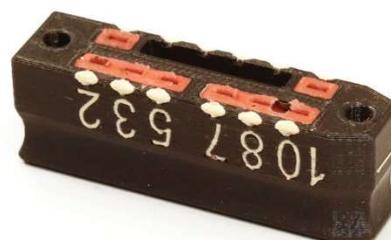
Dieses im Zweifarbdruk gefertigte Druckteil kann wie eine Federleiste auf die Messerleisten für den RoeTest aufgesteckt werden und zeigt dann die korrekte Belegung direkt am Ort des Geschehens an:
