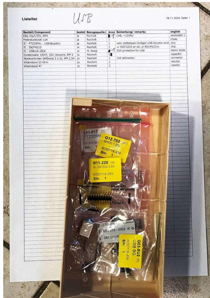
Die Bestückung geht dann anhand des Bestückungsaufdrucks der Platine sowie ggf. nach einem Blick in die Anleitung sowie die bereitgestellten Referenzfotos wie üblich vonstatten. Man beginnt mit etwaigen SMD-Bauteilen und arbeitet sich dann von den niedrigen zu den höheren Bauteilen durch.
