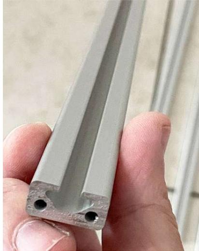
Diese Profile haben einen Querschnitt von 10mm x 20mm und besitzen zwei Bohrungen von ca. 3,3mm, die sich perfekt zu M4-Gewinden schneiden lassen.
