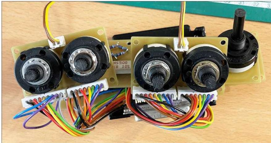
Diese Platinen sind trivial, haben aber durch die 17 anzusteuern Anoden sehr viele Anschlussleitungen.
