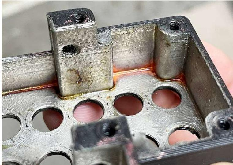
In dem Foto sieht man gut die Probleme bei der Badgalvanik: Die Abscheidung in den engen Ecken und Kanten ist minimal: man sieht dort anstelle von Nickel noch die dünne Kupferschicht. Um dieses Problem zu verringern, könnte man schon beim Design des Druckteils vorbeugen, indem man hier Hohlkehlen vorsieht. Für dieses Teil lasse ich das aber jetzt so, denn das Ergebnis ist trotzdem mehr als ausreichend.
