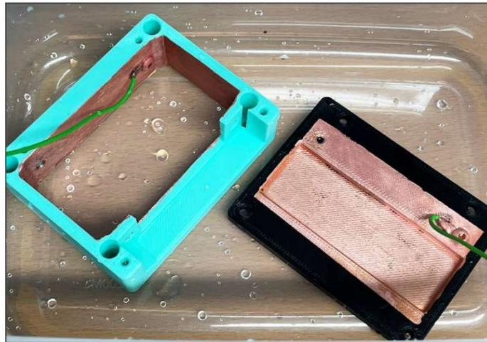
Weil das Kupfer ziemlich schnell hässlich oxidiert, wird – ebenfalls per Galvanik – noch eine Nickel-Schicht darübergelegt. Und an der minderen Qualität der Nickelschicht sieht man dann auch, dass es nicht gut war, dass ich den Kupferleitlack nur einmal aufgetragen hatte:
