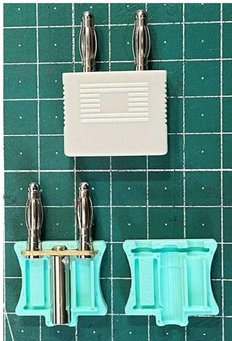
Es ist kompakter und griffiger - und auch die Hülse der Anschlussbuchse ist jetzt tiefer ins Gehäuse eingelassen. Die Halbschalen halten von selbst schon gut zusammen, sind aber zusätzlich noch mit Epoxy verklebt.
