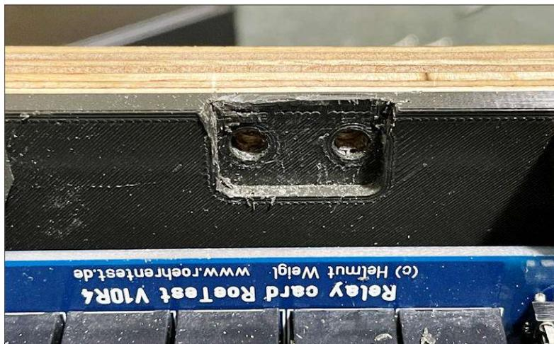
Eine richtig gute Lösung, diese Ausklinkung schon direkt in das Druckdesign einzuarbeiten, ist mir bisher nicht eingefallen: Der Rand von 4mm ist an dieser Stelle unbedingt nötig, damit der Kopierfräser zur Herstellung der Multiplexplatte daran geführt werden kann. Daher lasse ich es bei dieser Lösung - ich habe ja schließlich auch keine Massenfertigung von RoeTests geplant.
