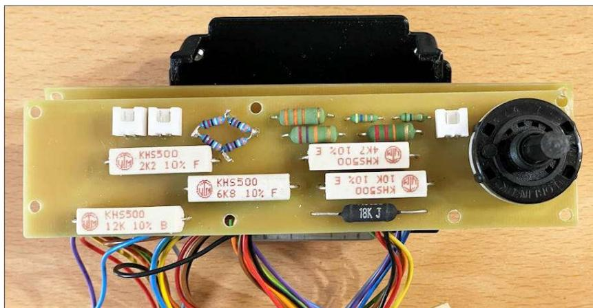
Um auf der sicheren Seite zu sein, habe ich Lastwiderstände so gewählt, dass sie auch bei einem Kurzschluss problemlos überlegen würden. Das ist vermutlich übertrieben, aber schaden kann es nicht. Man beachte hier links der Mitte oben die übliche parallel-seriell-Schaltung von 4 Widerständen, um die zulässige Verlustleistung zu vervierfachen, wenn die gesuchten Widerstandswerte mal nicht in der nötigen Leistung lieferbar sind.
