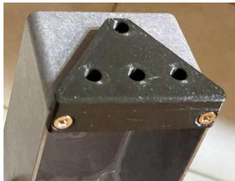
Schließlich bohrt man die kleinen Löcher mit Stufenbohrern auf das richtige Maß auf:
