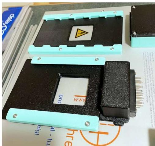
Diesen Adapter, der sich dank 3D-Druck sehr leicht herstellen lässt, kann man auf mein Schienensystem aufsetzen und hat dann exakt dasselbe Schienenprofil wie im Original. Hier noch weitere Ansichten:
