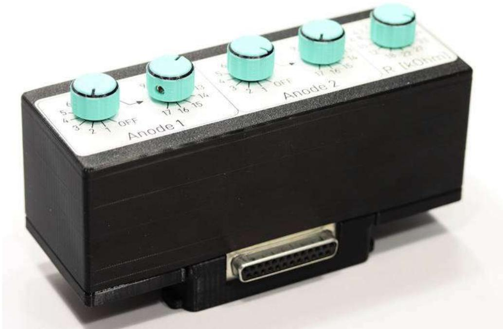
Der Nixie-Adapter wird analog zur Insert-Box einfach zwischen den RoeTest und die Fassungsbox der Nixie-Röhre geschaltet. Der Anschluss an den RoeTest erfolgt über die 12-polige Messerleiste, für den Anschluss von Nixie-Fassungsboxen habe ich mich für 25-polige D-SUB-Steckverbindungen entschieden: Diese sind extrem preisgünstig und reichen von ihren elektromechanischen Eigenschaften her vollkommen aus. 17 Pins sind für Kathoden vorgesehen, an 8 Pins liegt Masse zur Erdung von Fassungen etc. an.
