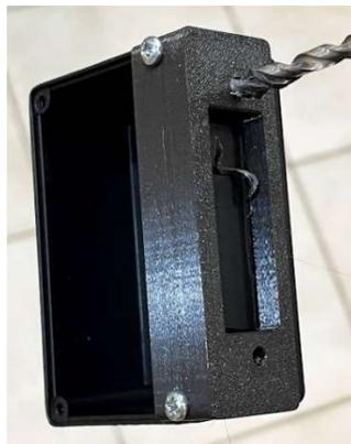
Durch den rechteckigen Ausschnitt der Schablone hindurch wird dann der Ausschnitt für die Messerleiste mithilfe eines Cuttermessers vorgeritzt:
