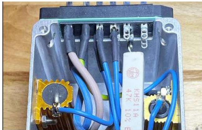
Bei der Kontaktierung der Widerstände an der Messerleiste habe ich an einer Stelle oben und unten verwechselt. Durch die falschen Widerstandswerte lag dann beim Abgleich der Strommessbereiche die falsche Stromstärke an und ich konnte einen Messbereich nicht abgleichen... Zum Glück war auch dieser Fehler nicht tragisch und schnell behoben.
