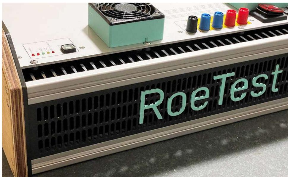
Der Kühlkörper ist gut verpackt, stellt keine Verletzungsgefahr mehr dar, hat aber trotzdem eine sehr gute Luftzufuhr.
