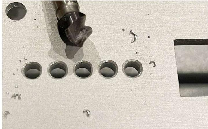
Und schließlich empfehle ich auch noch das rechteckige Loch für die USB-Buchse an der Unterseite mit einer Schlüsselfeile zu bearbeiten, so dass deren Schrumpfschlaulisolierung (siehe Originalanleitung) nicht beschädigt wird.
