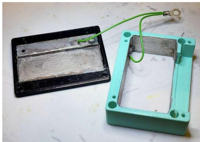
Ich hatte da schon wesentlich bessere Ergebnisse. Aber nachdem die Metallschicht im Inneren verborgen ist, kommt es auf das Aussehen nicht an. Denn die Funktion der Abschirmung ist damit auf jeden Fall gegeben. Natürlich müssen die beiden Metallschichten auf den Druckteilen mit Masse verbunden werden. Dies geschieht einfach mit den bereits für die Galvanik vorhandenen Leitungen:
