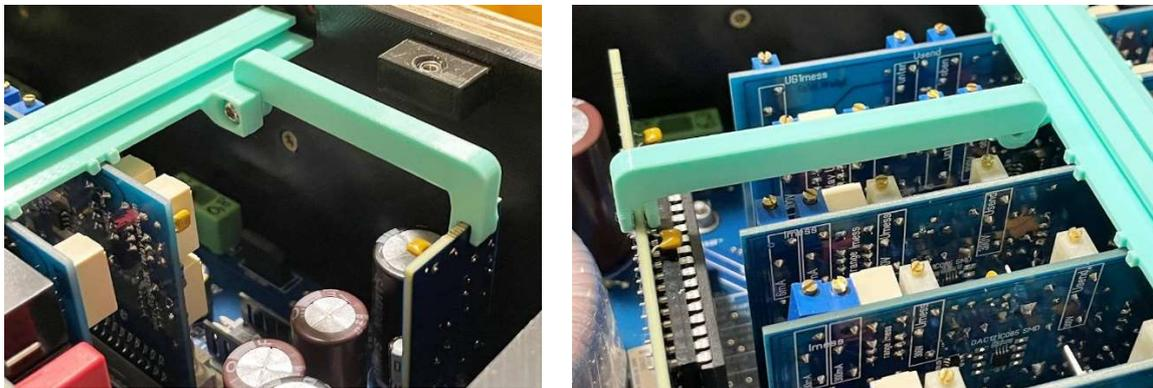
Die beiden Seitenarme werden nicht durch die Alu-Querstrebe unterstützt, sondern am Ende durch das Bodenblech in Position gehalten.
