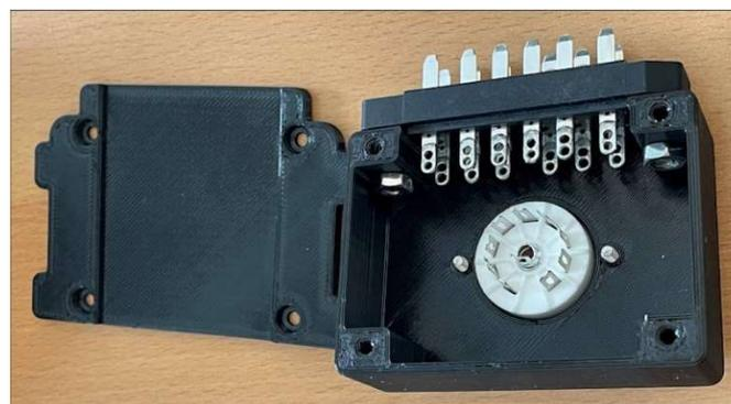
Man muss die Box also nur noch verdrahten. Dabei erdet man auch alle Schrauben und sonstigen Metallteile - lediglich bei den Schrauben zum Verschließen der Box auf der Unterseite spart man sich das:
