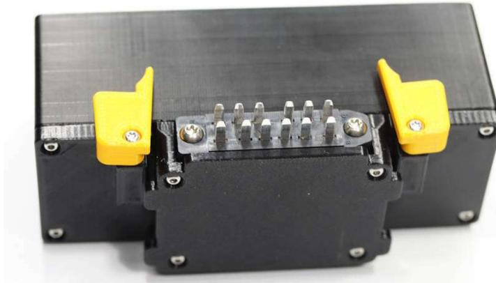
Durch diese Fixierung kann man leichter Nixie-Fassungsboxen wechseln, ohne den Nixie-Adapter mit abzuziehen.
