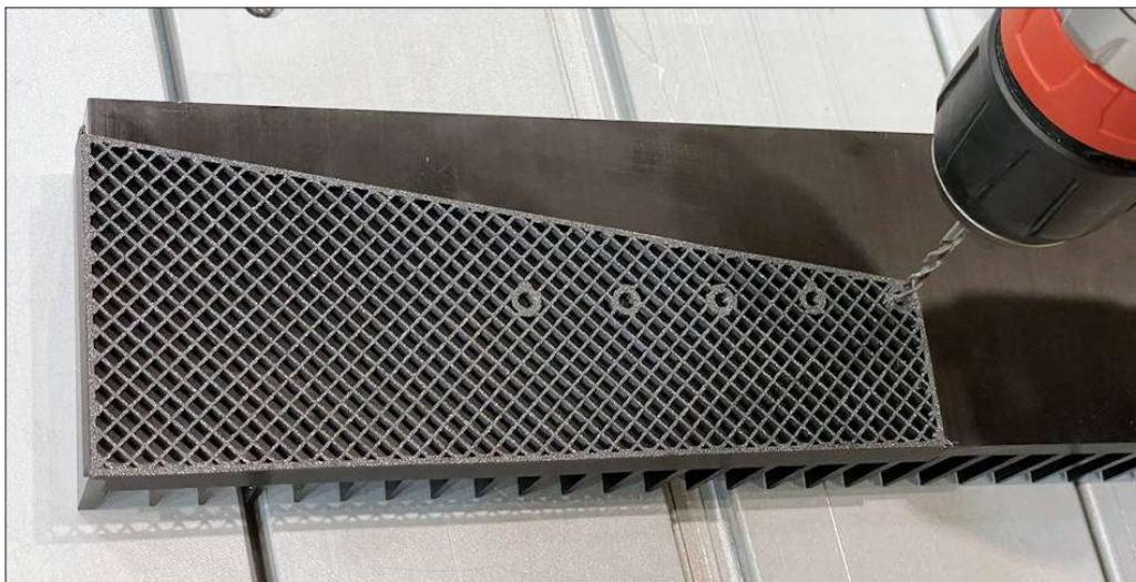
Der Druck solcher größeren Schablonen geht ohne top- und bottom-Layer sehr flott und verbraucht wenig Material. Mit der Schablone sitzen alle Bohrungen perfekt, ohne dass ich fummelig messen, anzeichnen und zielen muss. Mit dem Akkuschauber und der Schablone wird übrigens nur kurz vorgebohrt. Der Rest wird dann an der Ständerbohrmaschine und dem korrekten Kernlochdurchmesser durchgebohrt und danach mit dem entsprechenden Gewindeschneider und etwas Öl geschnitten.
