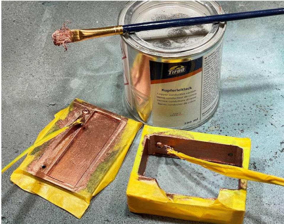
Zuvor habe ich bereits Anschlussleitungen mithilfe von Löt-Ösen und M3-Schrauben an den Druckteilen befestigt. Nachdem der Lack ein paar Stunden getrocknet ist, sollte man nochmal eine zweite Schicht Lack aufbringen. Das habe ich hier nicht gemacht und so sieht auch das Ergebnis am Ende nicht ganz so toll aus. Funktionieren tut es aber trotzdem.
