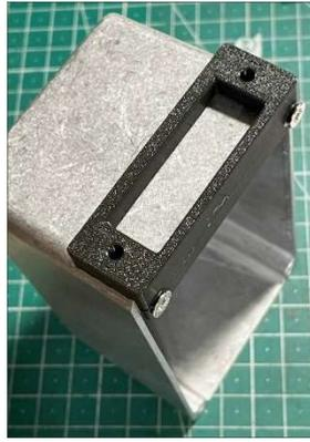
Die Löcher werden durch die Schablone hindurch gebohrt und der rechteckige Ausschnitt angezeichnet. Er wird nach Entfernen der Schablone herausgesägt und mit der Feile fertig bearbeitet. In die Löcher werden Gewinde geschnitten und schon passt die Buchse perfekt:
