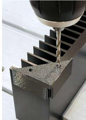
Nach dem Vorbohren sollte man die Position sicherheitshalber noch gegen die Löcher der Frontplatte prüfen. Die zwei dann noch fehlenden Löcher werden später einfach mit der Frontplatte als Schablone positioniert, nachdem man die Frontplatte bereits an den beiden ersten Löchern festgeschraubt hat.
