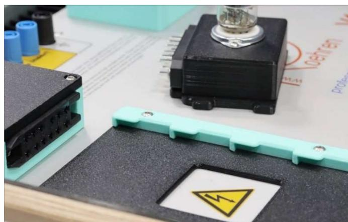
Diese Bajonett-artige Form erfüllt zunächst denselben Zweck, wie die Schienen beim Original. Der Vorteil ist nun aber, dass man die Fassungsboxen nicht mehr über die gesamte Länge der Schienen einschieben muss, sondern nur um gut 1cm bis zum Einrasten. Dadurch kann man die Schienen auch länger machen, wodurch auch längere Konstruktionen (das sehen wir später noch!) über die gesamte Länge gehalten werden.
