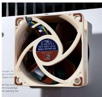
So ein Lüfter ist deutlich leiser und langlebiger, dafür aber auch deutlich teurer. Ein weiterer Nachteil ist, dass die Kabeldurchführung in der Frontplatte nicht passt. Hier muss man die einfach ein wenig einer Schlüsselfeile nachbearbeiten. Und die Farbgebung des Lüfters sticht sich sehr mit dem Farbkonzept meines RoeTest. Daher habe ich dem Lüfter nicht nur ein Lüftergitter spendiert, sondern gleich eine ganze Haube dafür designt, die den Lüfter vollständig einpackt:
