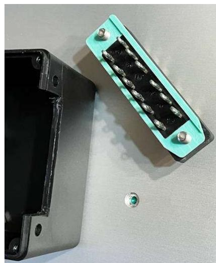
Mithilfe des Unterlegplättchens stimmt der 90-Grad-Winkel der Messerleiste perfekt:
