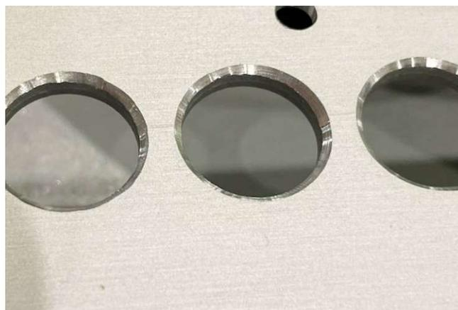
Das erleichtert das Einsetzen der großen Platine und schont die Buchsen. Entgraten sollte man auch die 3mm-Löcher für die LEDs - auch hier nur an der Unterseite der Frontplatte:
