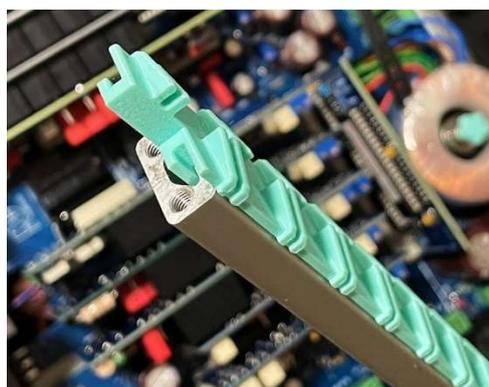
Dieses zweiteilige Design der Druckteile gestattet einen Druck ohne Stützstrukturen. Außerdem ist die Orientierung beim Druck optimal, so dass sich eine sehr robuste Lösung ergibt.
