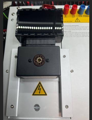
Ich habe deshalb eine durchgehende, klare 4mm Acrylplatte mit entsprechenden Auslässen und Bohrungen gelasert und aus schwarzem 3mm Acryl eine kleine verzahnte Box konstruiert.
