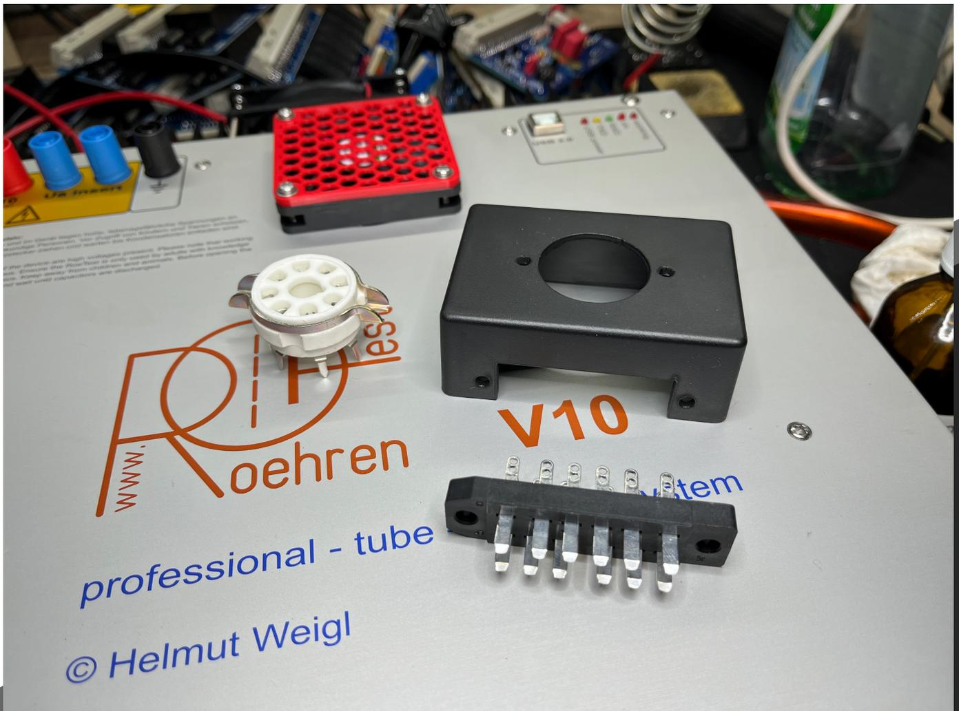
Der Laser eignet sich auch hervorragend dazu, die Ausschnitte für die Messerleisten und die Röhrenfassungen in die Fassungsboxen zu schneiden.
