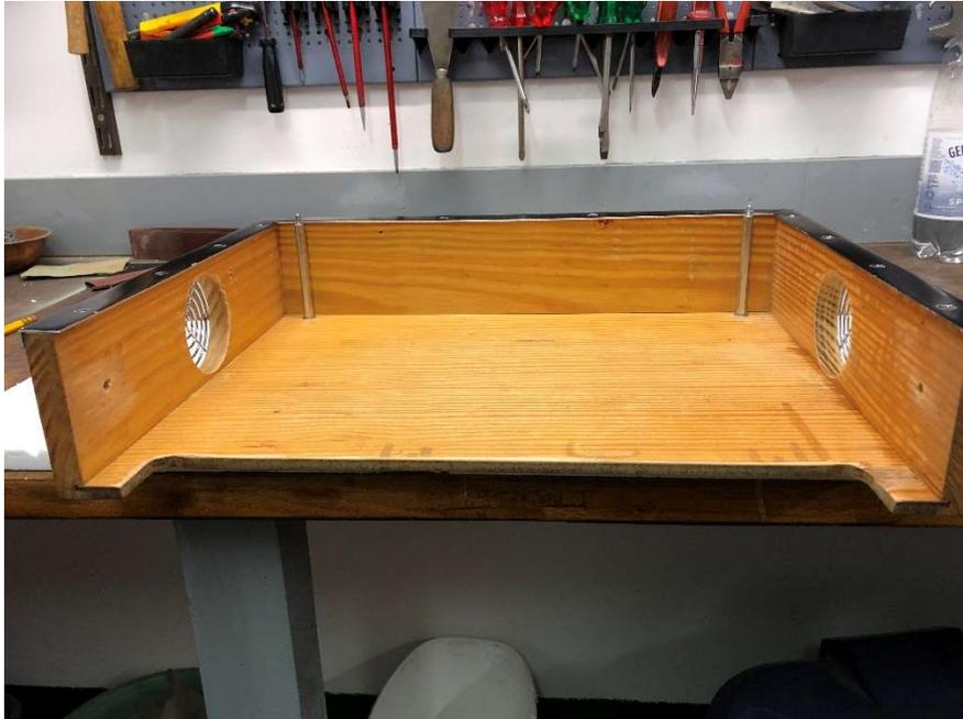
Über die Stehbolzen kamen je ein Stück Silikonschlauch zur Isolierung. Zur Halterung der Platinen hatte ich noch etwas Dichtband aus dem Trockenbau übrig, dieses eignete sich wunderbar dafür.
