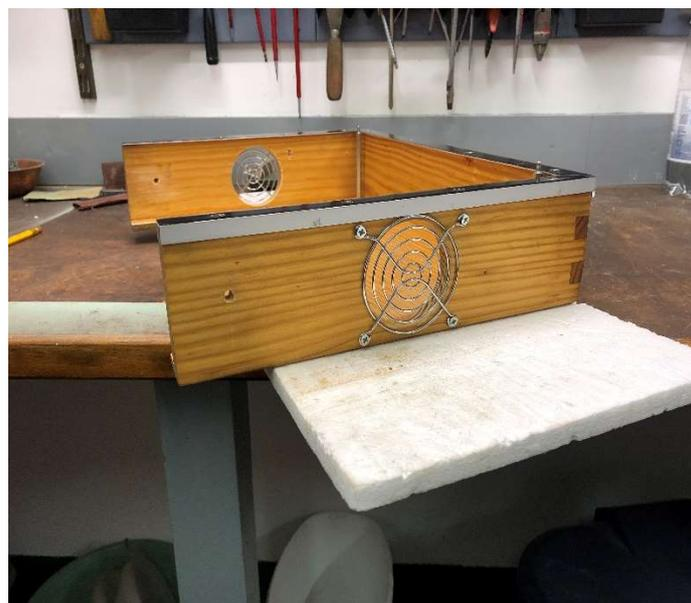
Die Kiste wurde anschließend sauber verschliffen und mit einer Holzschutzlasur gestrichen. Der obere Rand der Aluprofile wurde schwarz verschönert. Und zur Befestigung des Gerätes wurden Stehbolzen eingesetzt.
