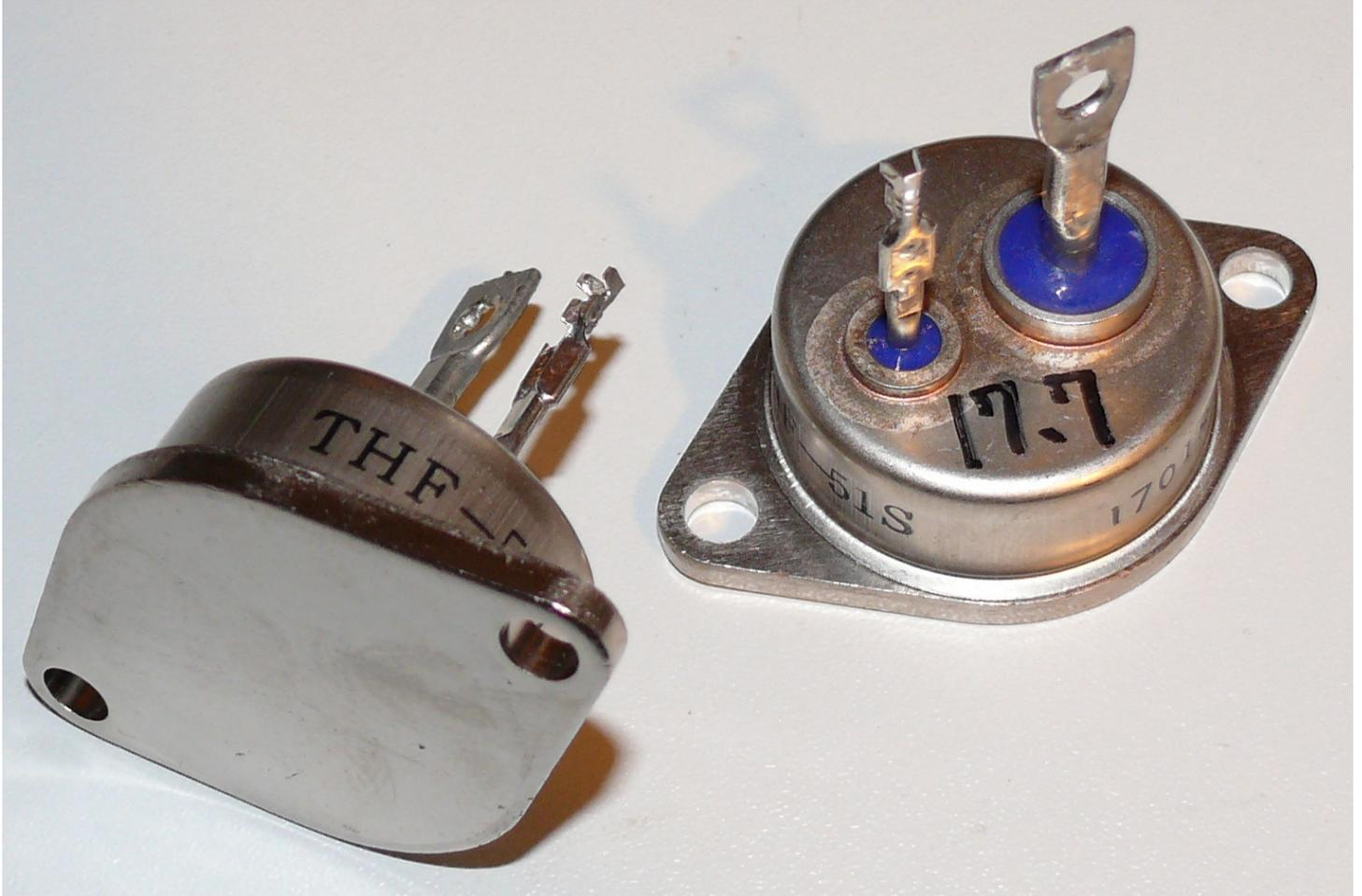
SIT's sind Leistungs-FET's und wurden in den 1960'igern erfunden. Um 1980 herum erfolgte kurzzeitig die Herstellung und Anwendung dieser Bauteile in Japan. SIT's sind geeignet für Schaltanwendungen hoher Frequenz, hohe Spannungen und große Leistungen. Sie wurden auch für Audiozwecke in Verstärkern eingesetzt (z.B. Sony und Yamaha).
