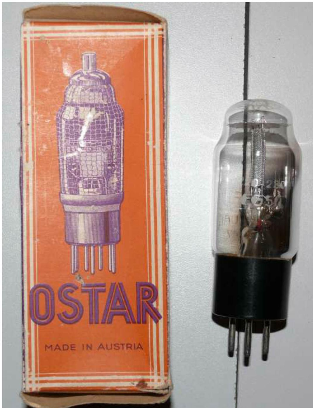
Anfang der 1930iger Jahre fertigte die Firma Ostar (Gustav Ganz, Wien) sog. Hochvolt-Röhren. Die Spannung der Heizfäden wurde so ausgelegt, daß diese direkt aus dem Stromnetz gespeist werden konnten. Somit wurde ein Heiztrafo oder Serienschaltung und Vorwiderstände entbehrlich.
