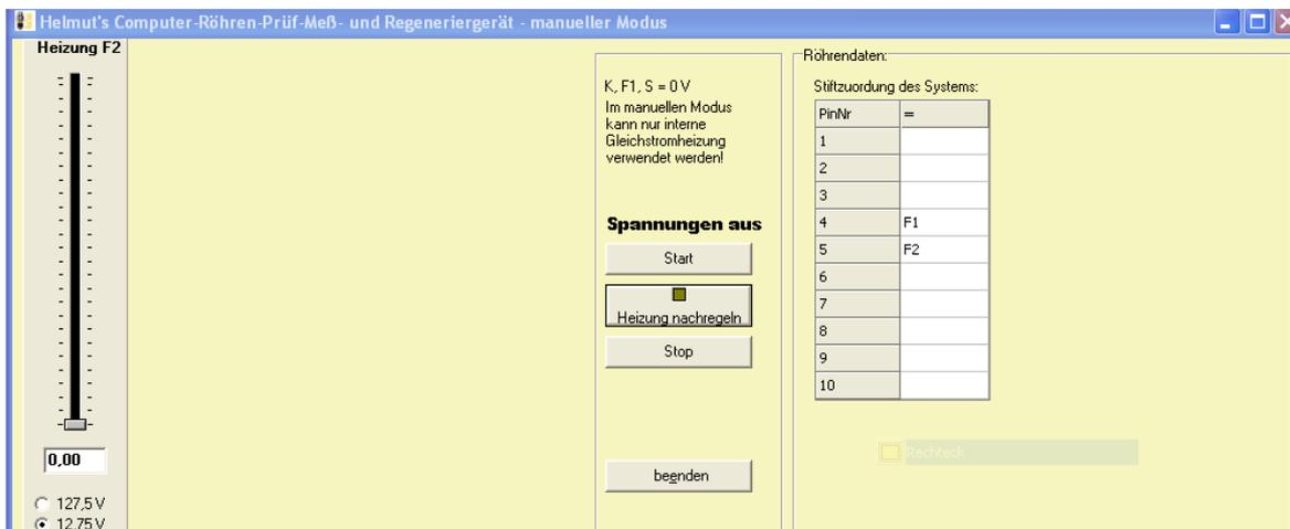
Heizspannung und Heizstrom sind in die Felder einzutragen.
