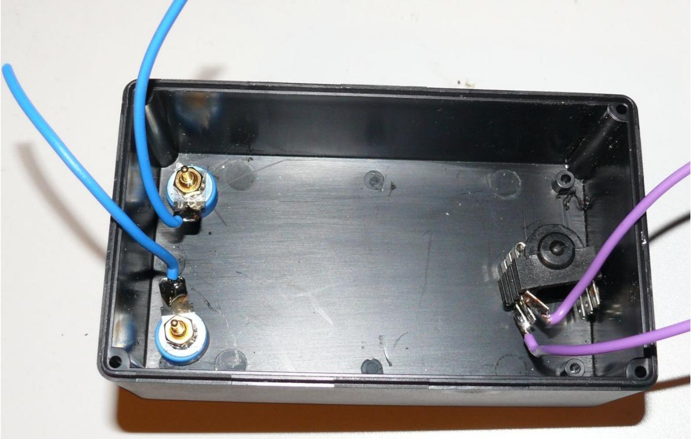
Der Trafo wird eingeklebt. Dabei wird seitlich ein Stück Plastik eingeklebt, damit der Trafo gut im Gehäuse sitzt. Störende Plastiknasen im Gehäuse sind vorher zu entfernen.
