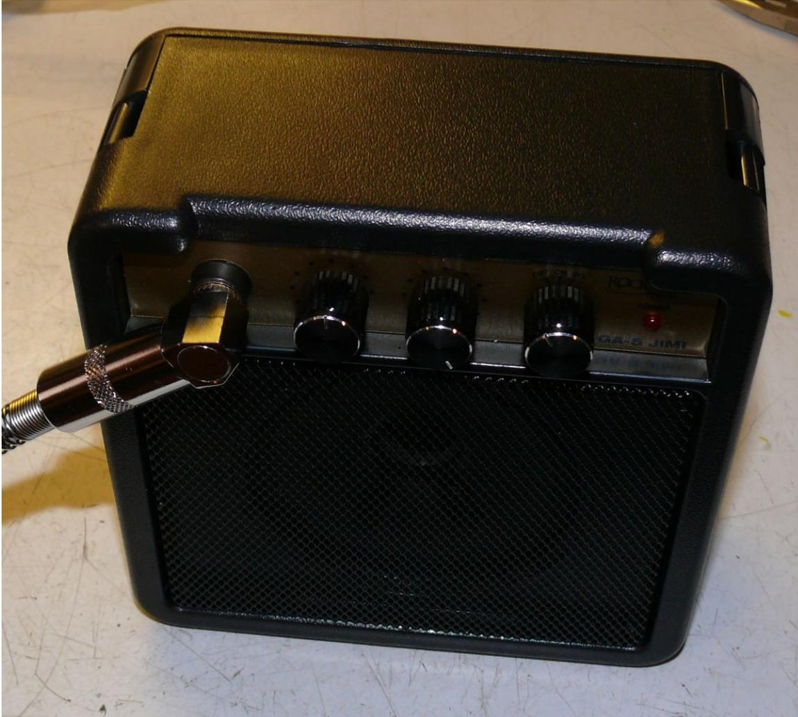
Dieser Verstärker kann mit einer Batterie betrieben werden. So handelt man sich kein zusätzliches Brummen durch ein Netzteil ein.
